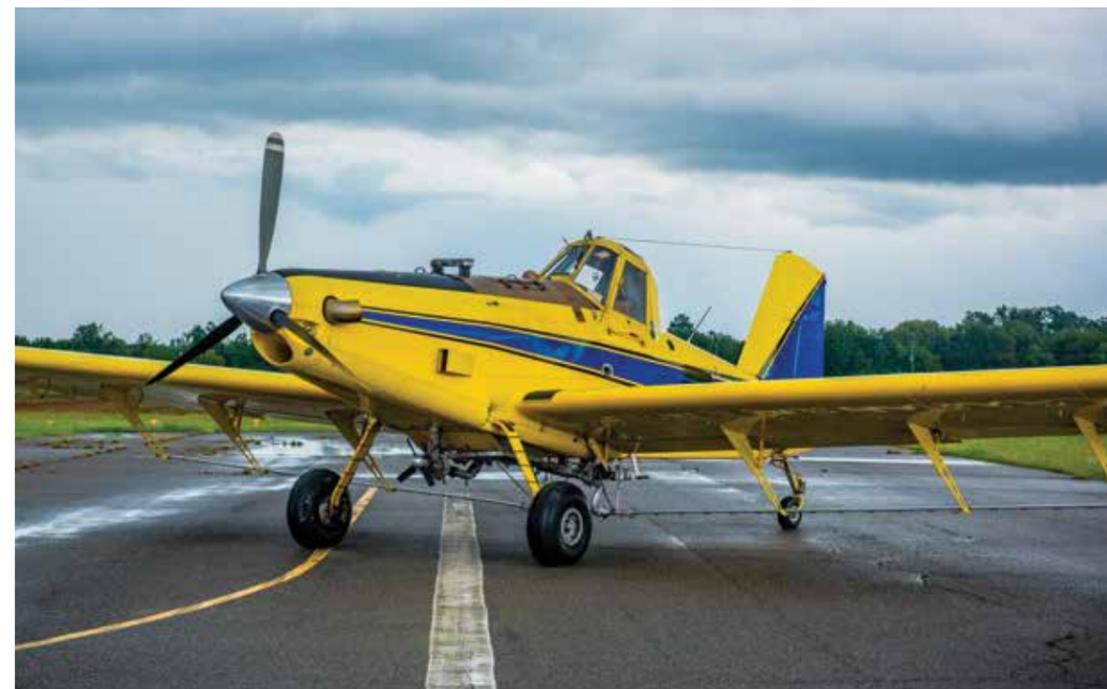
El AT-402B está diseñado para el operador que utiliza pistas cortas. Con un compacto y eficiente fuselaje, y una silenciosa, poderosa y confiable motor PT6A, es una de las opciones más populares entre los operadores que quieren cambiar su pequeño avión de pistón.
